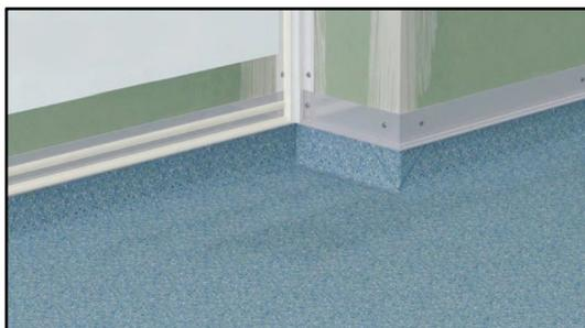
Unser neues PVC-Boden-zu-Wand-Profil verleiht Vinyl-Boden- und Wandverkleidung einen saubereren und präzisen Abschluss. Diese einfach zuzuschneidende und zu montierende Zierleiste ermöglicht den Austausch des Vinylbodenbelags, ohne dass eine der Platten ausgetauscht werden muss. Der Abstandshalter bietet den perfekten Spalt für Silikondichtmasse und der Vinylboden kann sicher unter der Lasche an der Basis der Verkleidung befestigt werden.
