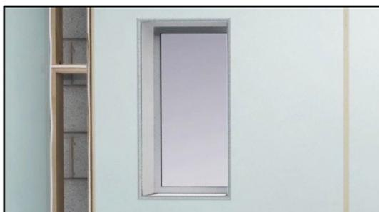
Nutzen Sie für den Abschluss eines Wandpaneels mit einer Fensterbank unser Viertelabschlussprofil (Typ E), welches Sie an der Ecke auf 45° Gehrung schneiden können.
