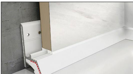
Das innovative und stilvolle zweiteilige Duschwannen- und Badewannenabdichtungssystem von Multipanel® besteht aus einem PVC-Streifen und einem leistungsstarken weißen Silikon. Die „Bewegungsfuge“ dehnt sich aus und zieht sich zusammen, um eine zuverlässige Bodendichtung zu bieten. Lieferung in Längen von 1,85 m, 2 Stück pro Packung.
