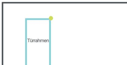
1. Beginnen Sie mit der Montage der Wandpaneele an der Türzarge und arbeiten Sie dann im Uhrzeigersinn weiter.
