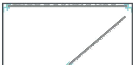
Silikonieren Sie die andere Seite des ersten Inneneckprofils. Wiederholen Sie Schritt 2 und 3. Setzen Sie ein Abschlussprofil (Typ C), falls erforderlich.
